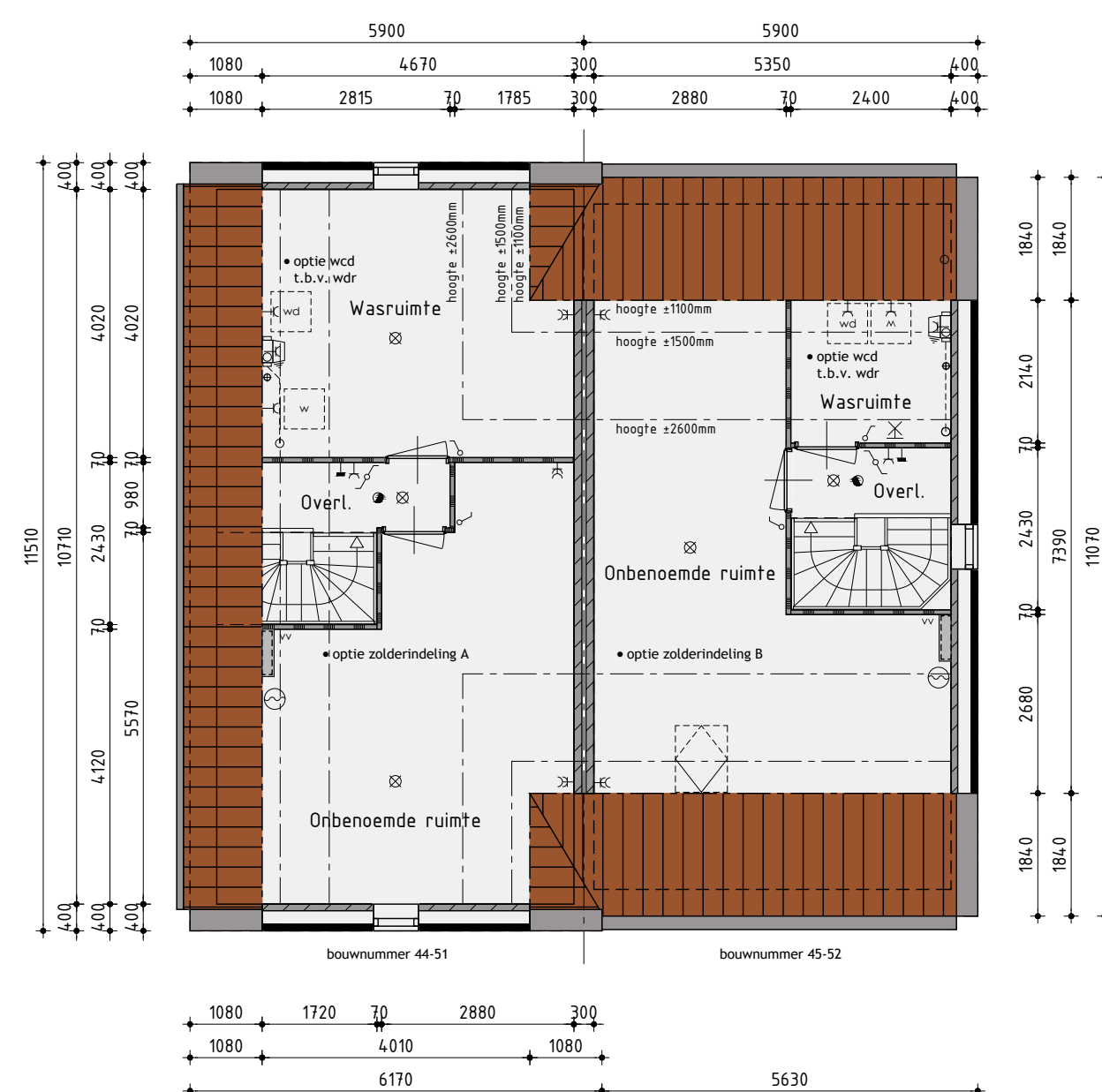
2de Verdieping v.z.v. vloerverwarming
