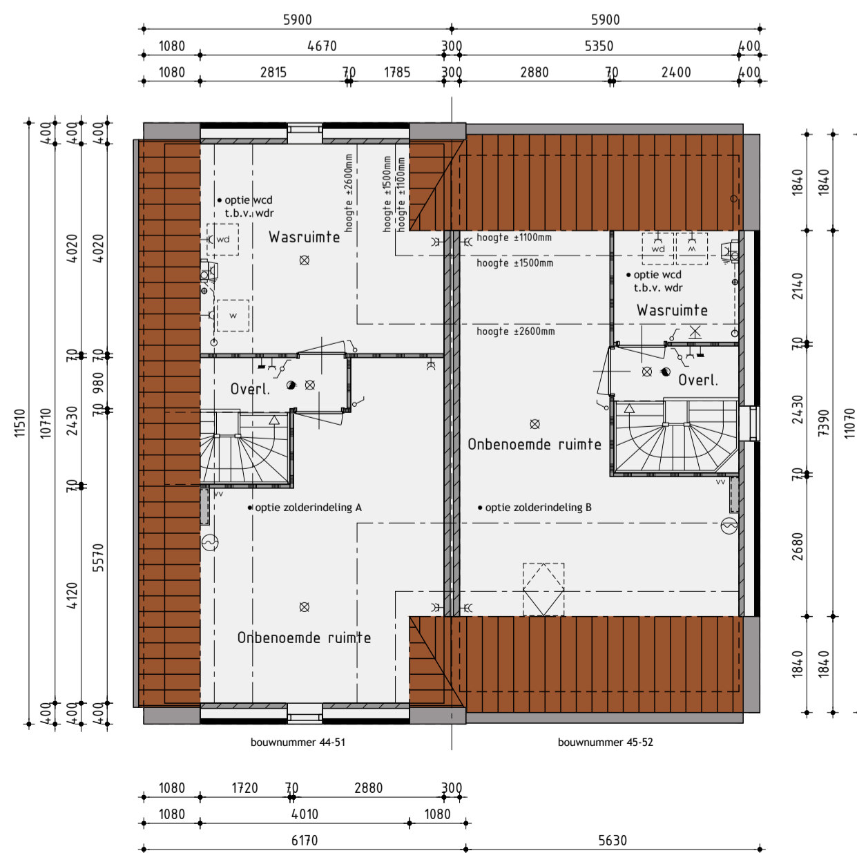
2de Verdieping v.z.v. vloerverwarming
