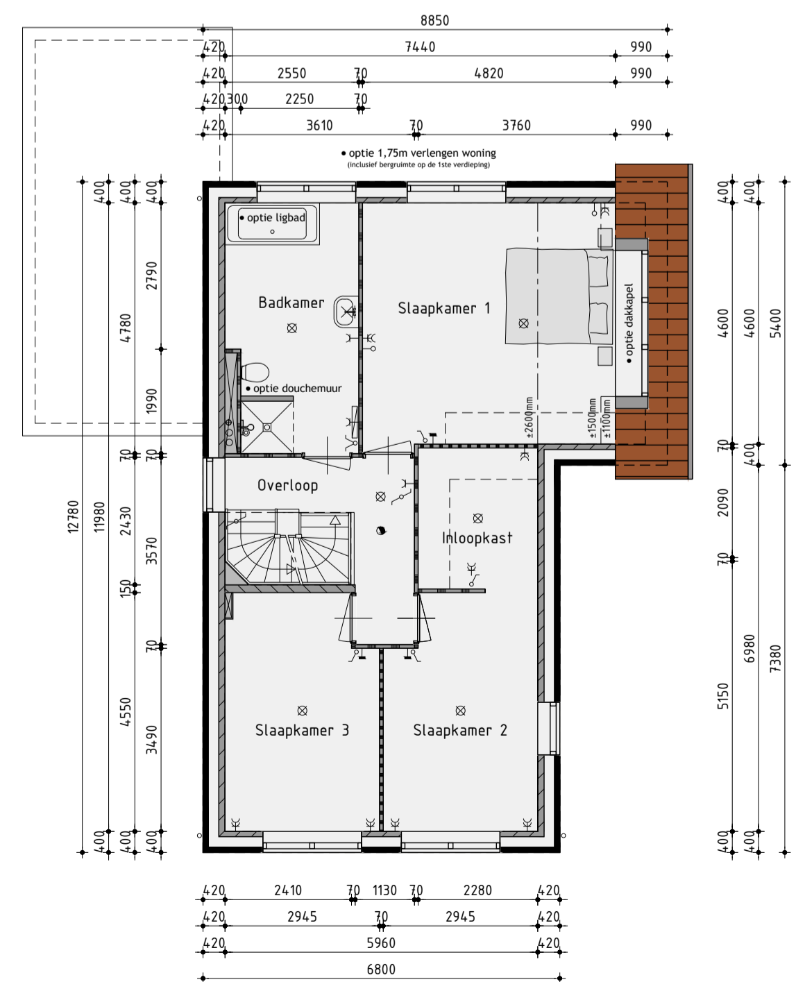
1ste Verdieping v.z.v. vloerverwarming
