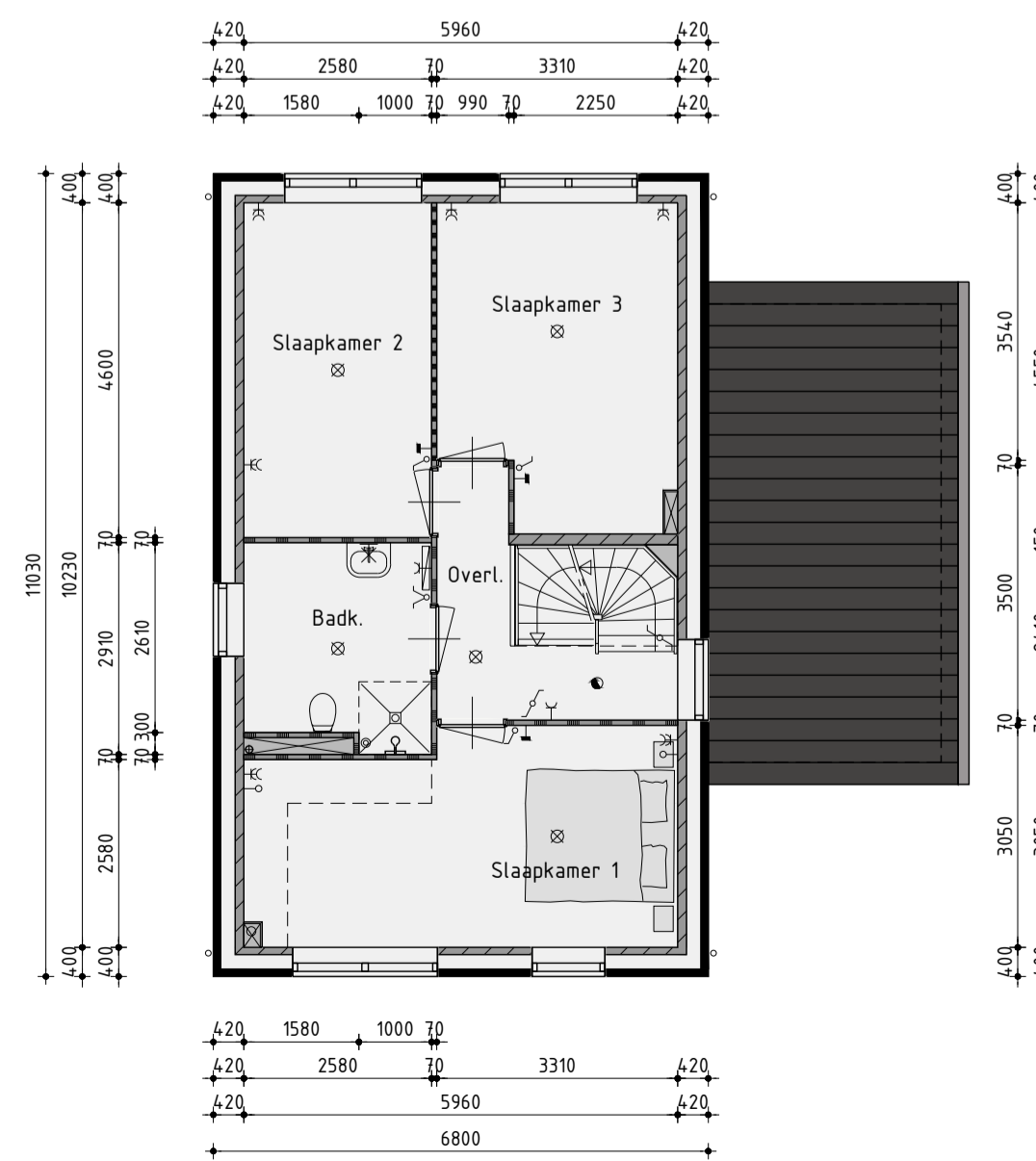
1ste Verdieping v.z.v. vloerverwarming
