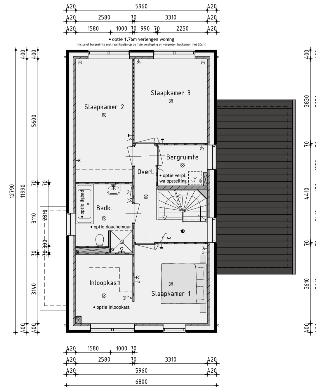
1ste Verdieping v.z.v. vloerverwarming
